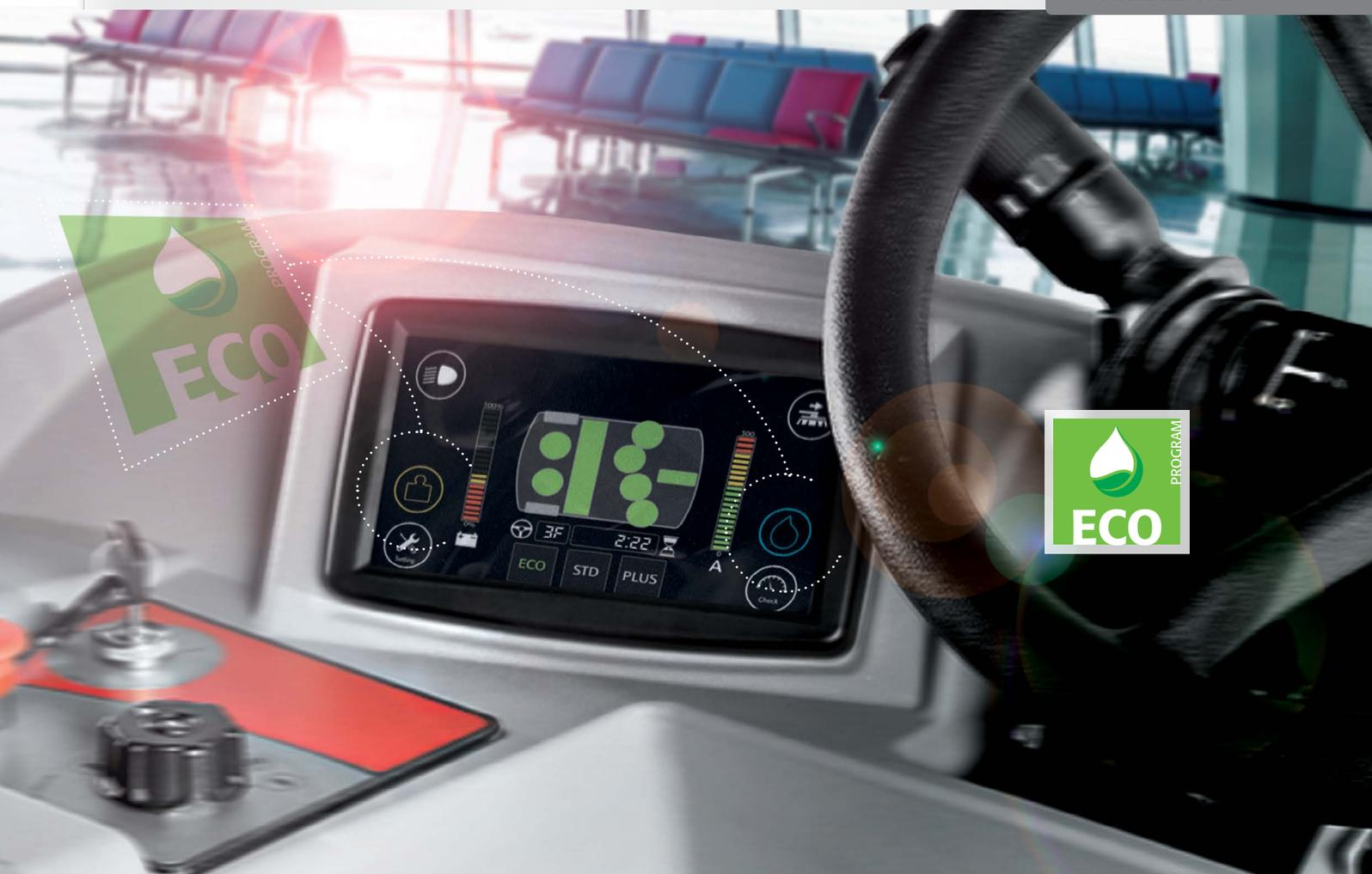
C130 adotta tecnologie che aiutano a risparmiare risorse. Se si eseguono, infatti, le operazioni di pulizia in modalità ECO, l'erogazione di acqua, detergente e la pressione vengono ridotte al minimo.
