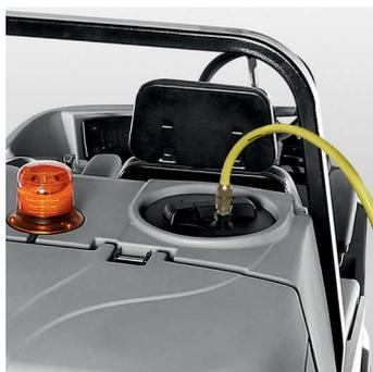
Un semplice dispositivo permette di riempire velocemente il serbatoio dell'acqua pulita senza la presenza dell'operatore
